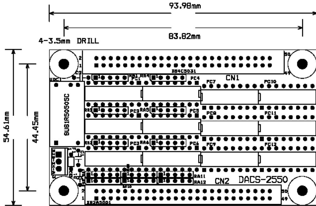
基板取付ねじ穴  $\phi$  3.5 mm 4か所
