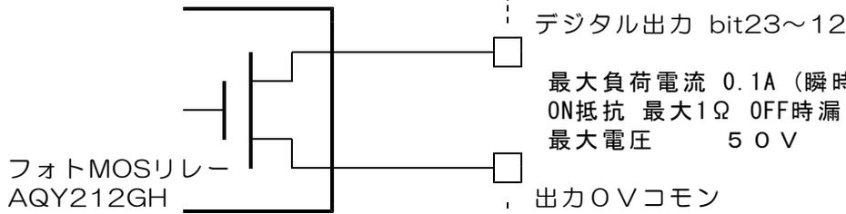
最大負荷電流 0.1A (瞬時最大0.5A)
