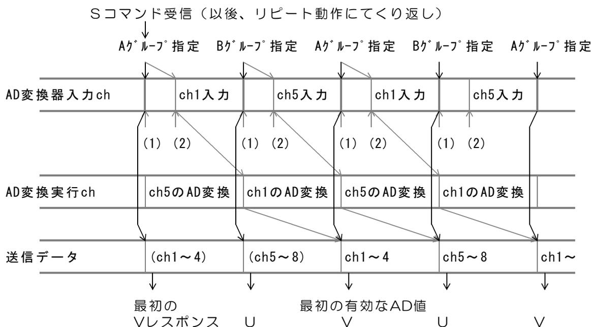
図中にch1入力およびch1のAD変換とあるのは、DACS-2510 1枚について表現したものです。4枚同時に動作しているため、ch1～4の入力、ch5～8の入力という意味になります。
