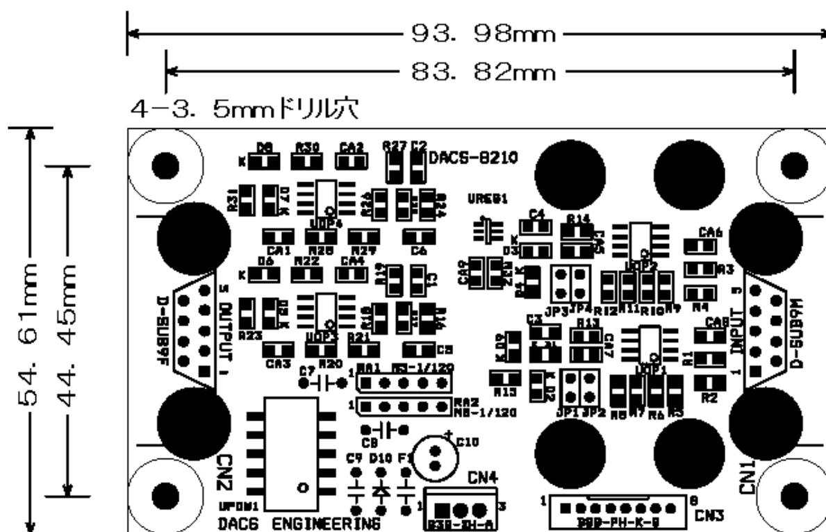
基板取付ねじ穴  $\phi 3.5\text{mm}$  4か所
