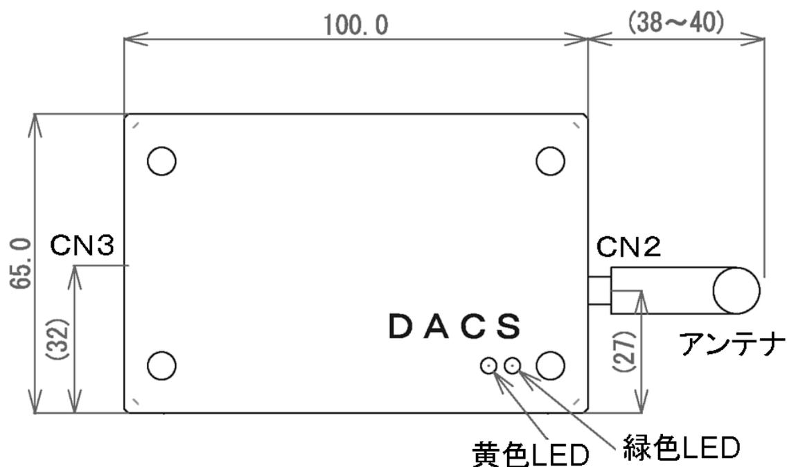
CN2 アンテナ取付用SMAコネクタ
